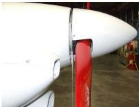
*Befestigungspunkt zwischen Motorcowling und Propellerspinner*
